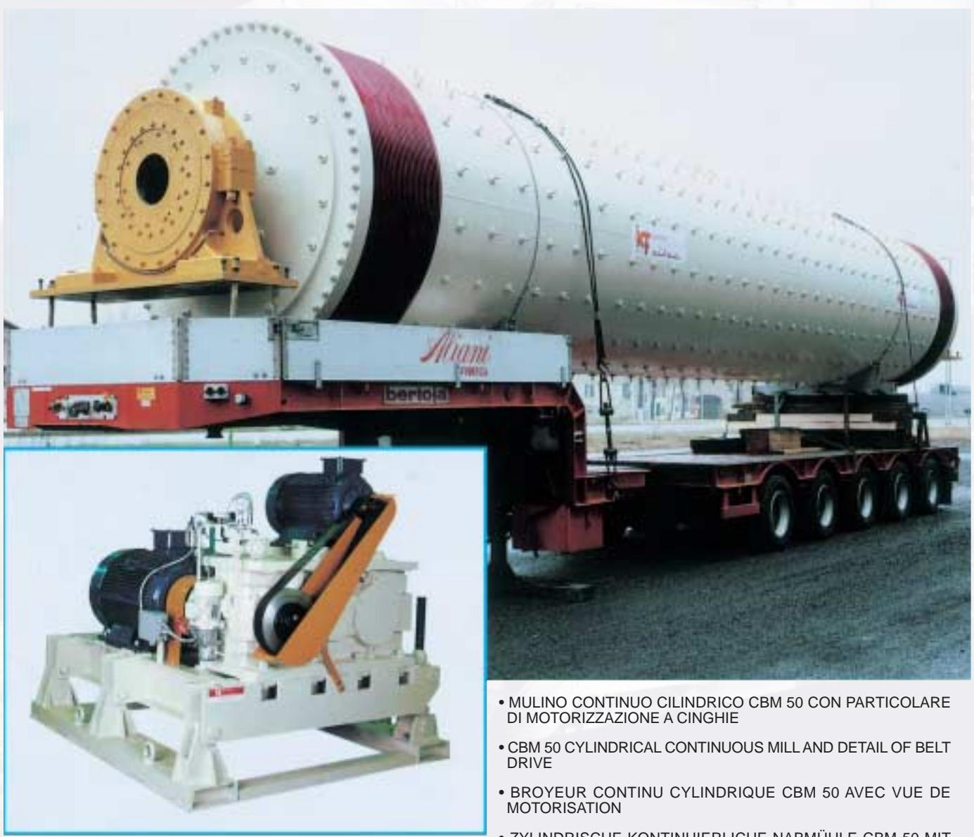
• MULINO CONTINUO CILINDRICO CBM 50 CON PARTICOLARE DI MOTORIZZAZIONE A CINGHIE
